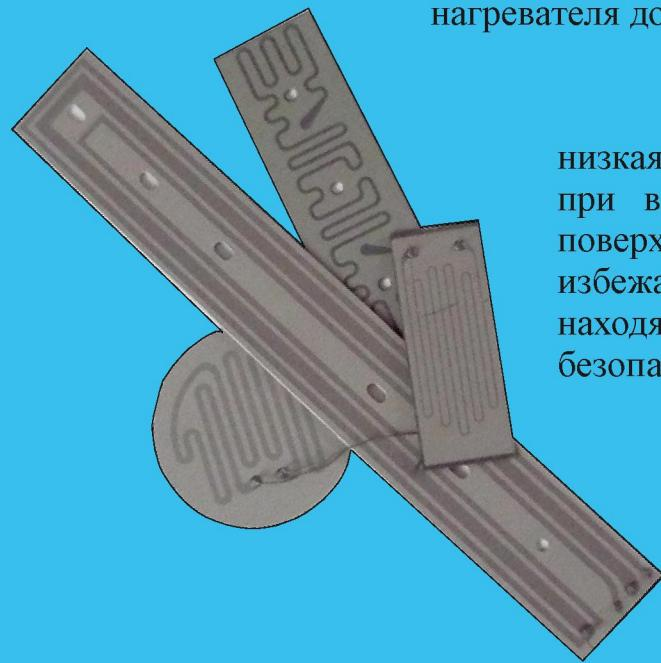
Плоские электрические нагревательные элементы по толстопленочной технологии изготавливают путем нанесения проводящей пастой на металлическую подложку, покрытую диэлектриком, токопроводящей дорожки, которая образует электрический контур. Это позволяет создать развитый электрический контур, который надежно изолирован как от основания, так и от окружающей среды.
